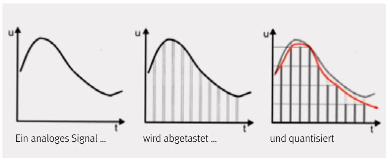
Abb. 8d: Wird die Zahl der Quantisierungsstufen herabgesetzt, so wird vor allem die Amplitude schlechter reproduziert.
